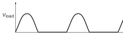
Figura 2.4: Salida del rectificador de media onda.
