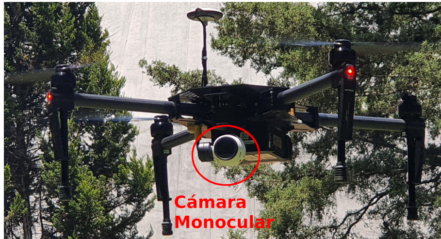
Figura 2.1: Sistema aéreo utilizado para la estimación de posición. Este dron cuenta con una controladora de vuelo, un módulo GPS y una cámara monocular de alta resolución.
