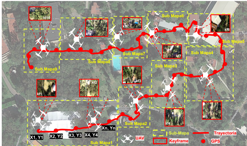
Figura 6.2: Adquisición del conjunto de datos, generación de submapas e imágenes representativas por cada región a lo largo de la trayectoria.
