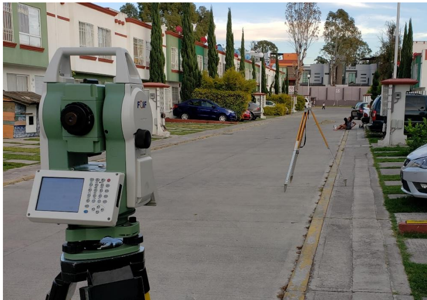
Fig. 48, Medición al objetivo pequeño con estación total Foif RTS-362
