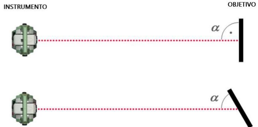
Fig. 50, Representación de ángulo de incidencia, Leica Geosystems.
