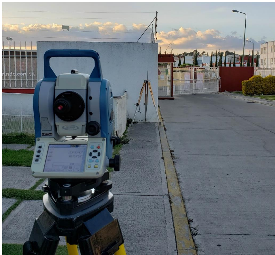
Fig. 46, Medición al objetivo pequeño con estación total Focus 8.
