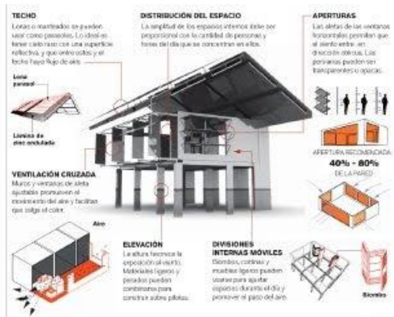
Ilustración 2-4 Diseño bioclimático de una casa
