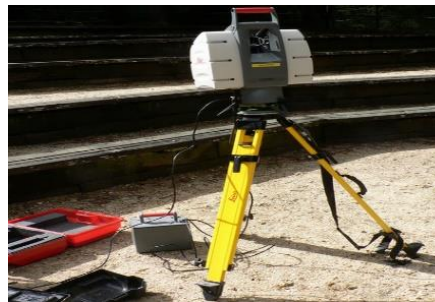
Figura 4. LIDAR tipo topográfico [3].
