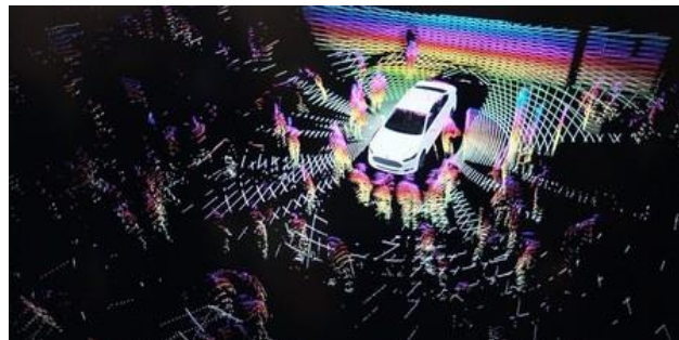
Figura 5. Figura.- 5 Nube de puntos (elementos generados por una cámara LIDAR)[3].
