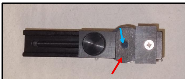
Fig. 21.- Fotografía de la muestra cubierta por una mascarilla circular antes de ser introducida en el equipo de medición para obtener la reflectancia especular.
