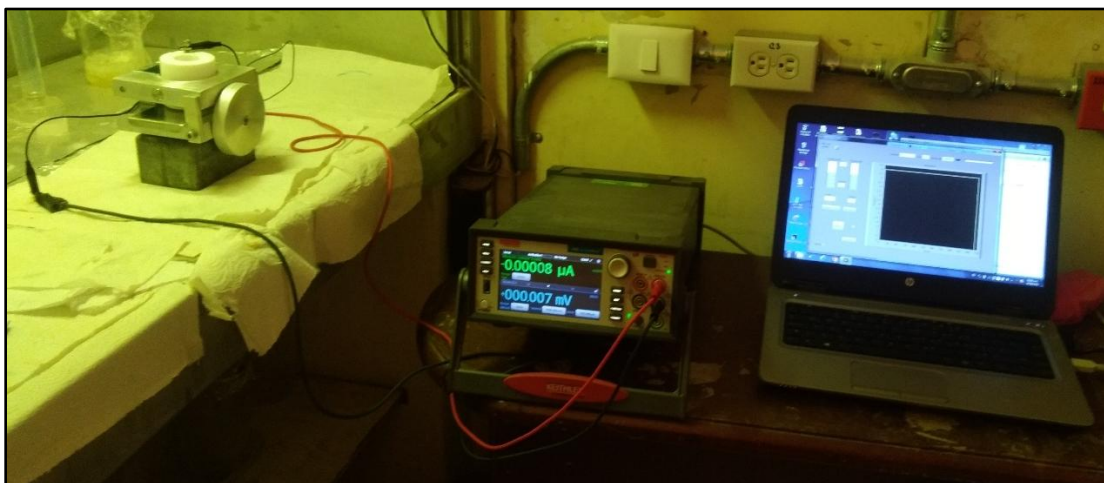
Fig. 17.- Fotografía del sistema para el proceso de anodización electroquímica, de izquierda a derecha, celda electroquímica, fuente de corriente y equipo de cómputo
