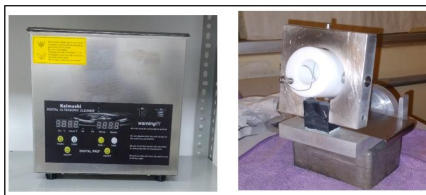
Fig. 16.- Fotografía de cubeta ultrasónica (lado izquierdo) utilizada para el proceso de lavado de obleas de silicio. Celda electrolítica (lado derecho) para la elaboración de PSi.
