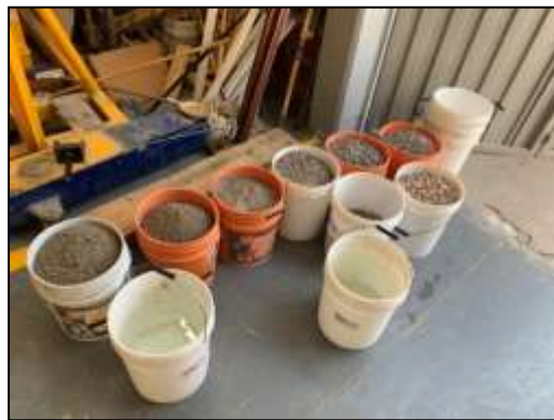
Figura 12 Agregados de concreto para el muerto.
