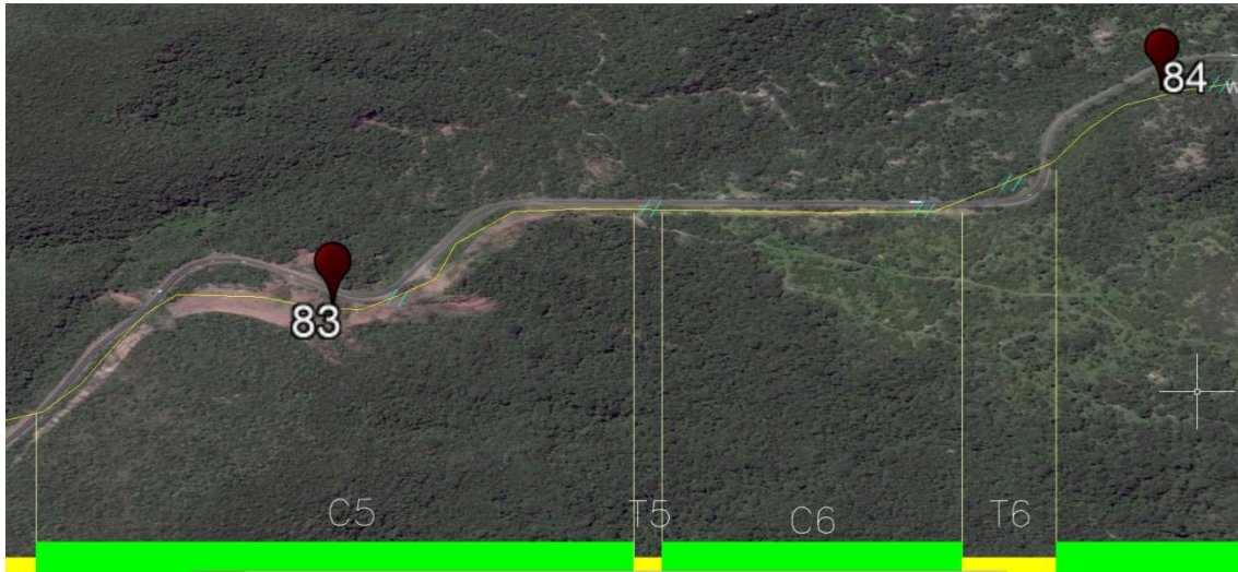
Fig. IV.5.2.3.9 IMAGEN SATELITAL DEL AFINE DE CURVAS DEL KM. 82+620 AL 83+820 Fuente: Modificado de (Google Maps, s.f.)
