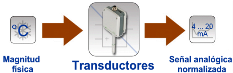
Figura 2.4: Esquema a bloques de un transductor (PCE, 2016)
