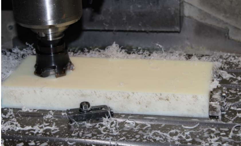
Figura 4.96: Planado de placa de polietileno
