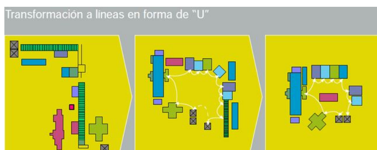
Figura 2.26: Transformación a líneas en forma de U (IIO, 2017)
