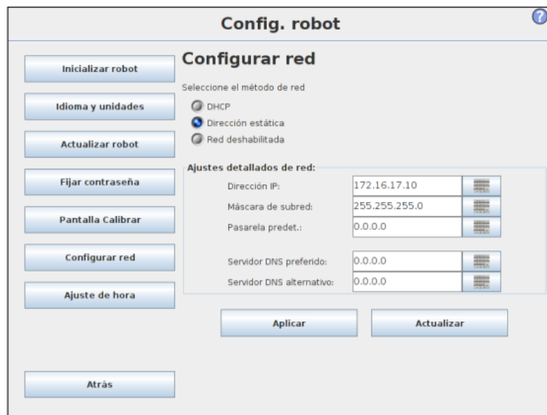
Figura 4.50: Configuración de red en robot (UR, 2016)
