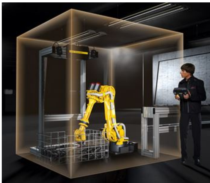
Figura 2.22: Volumen de trabajo de usuario (Fanuc, 2017)
