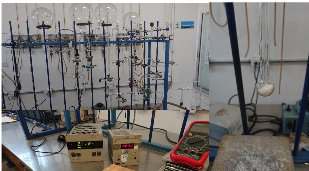
Figura 21. Equipo para el estudio cinético de adsorción.
