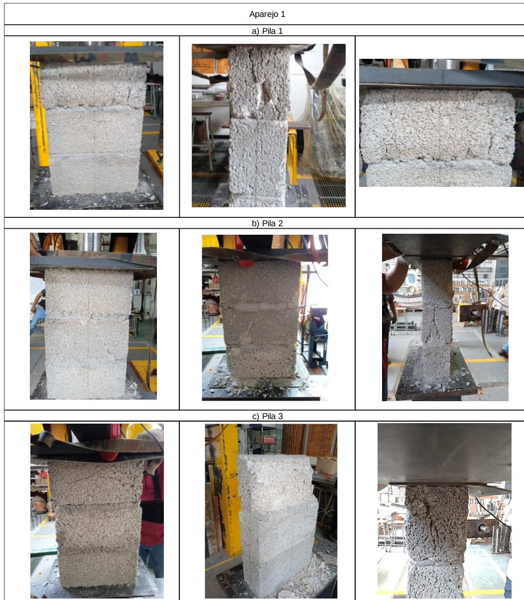
Figura 57 Tipos de fallas presentadas aparejo 1 (Autoría propia, 2024)
