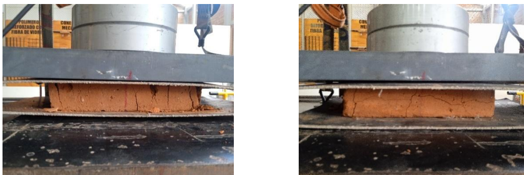
Figura 19 Ensayo de piezas de tabique (Autoría propia, 2024)
