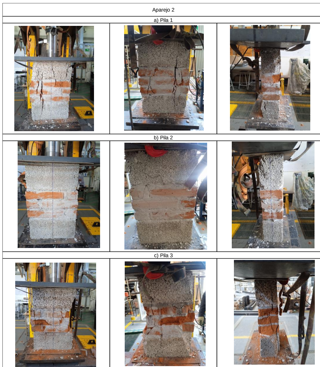
Figura 60 Tipos de fallas presentadas en aparejo 2 (Autoría propia, 2024)
