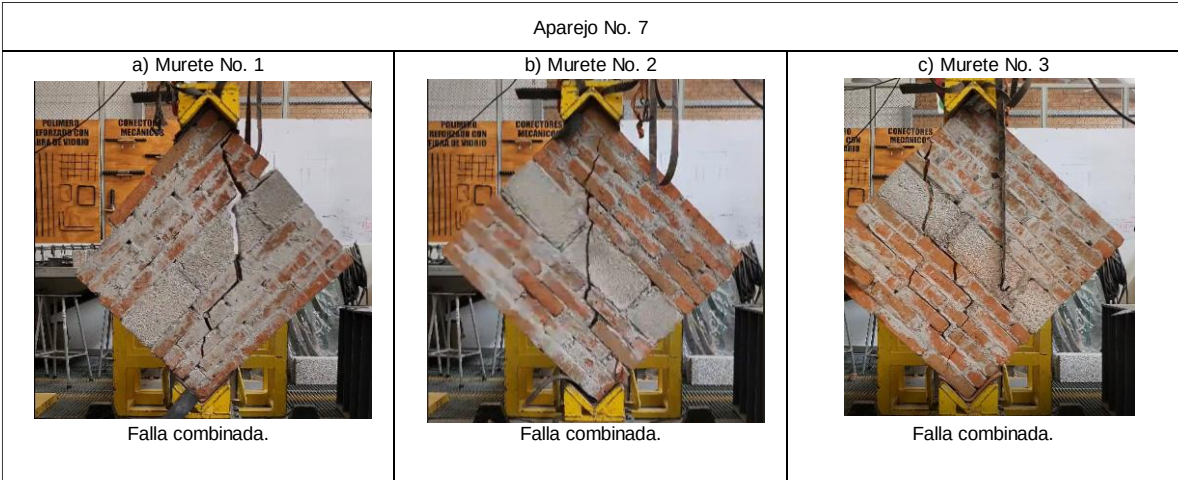
Figura 49 Tipo de falla presentada en aparejo 7 (Autoría propia, 2024)
