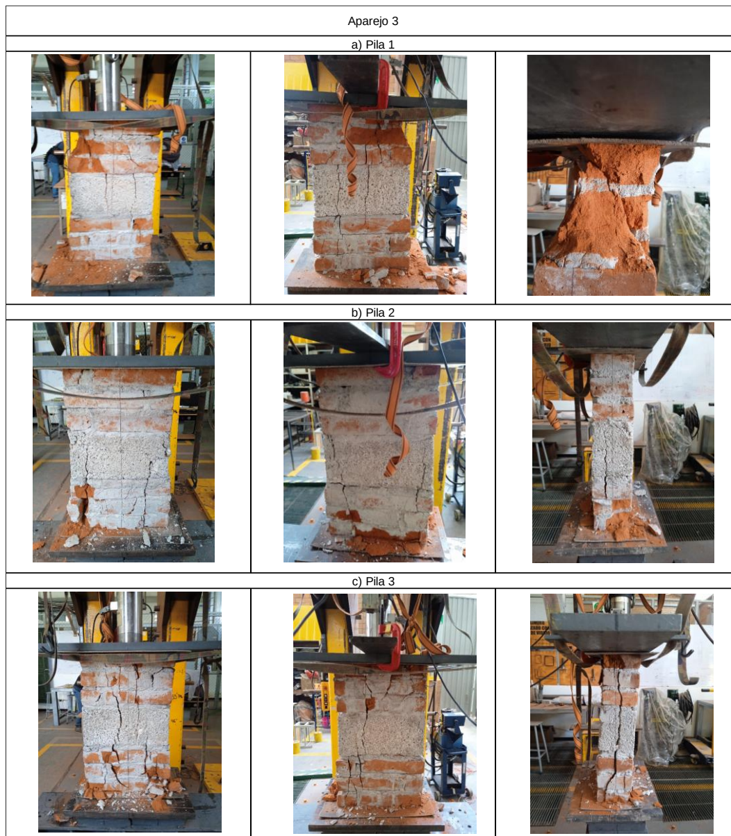
Figura 63 Tipos de falla presentada en aparejo 3 (Autoría propia, 2024)
