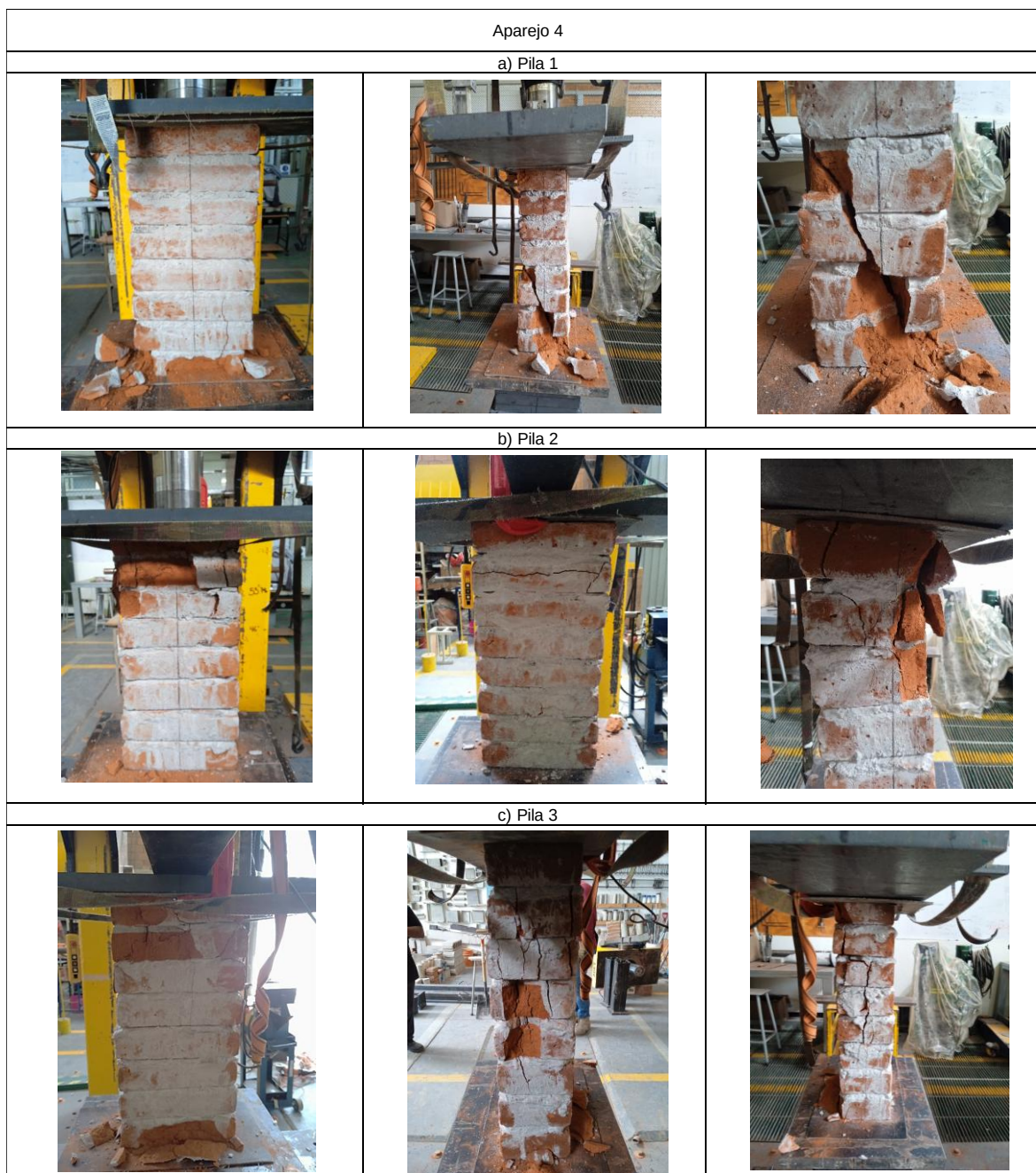
Figura 66 Tipos de falla presentadas en aparejo 4 (Autoría propia, 2024)
