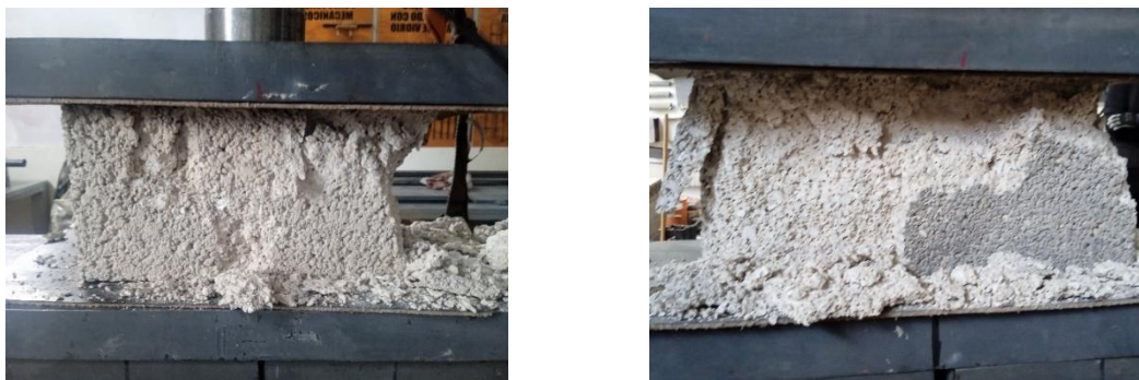
Figura 18 Ensayo de piezas de block (Autoría propia, 2024)
