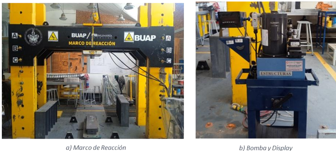
Figura 26 Marco de reacción y sistema de bomba de FI-BUAP (Autoría propia, 2024)
