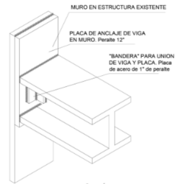
DETALLE 2 UNIÓN VIGA ESTRUCTURAL
