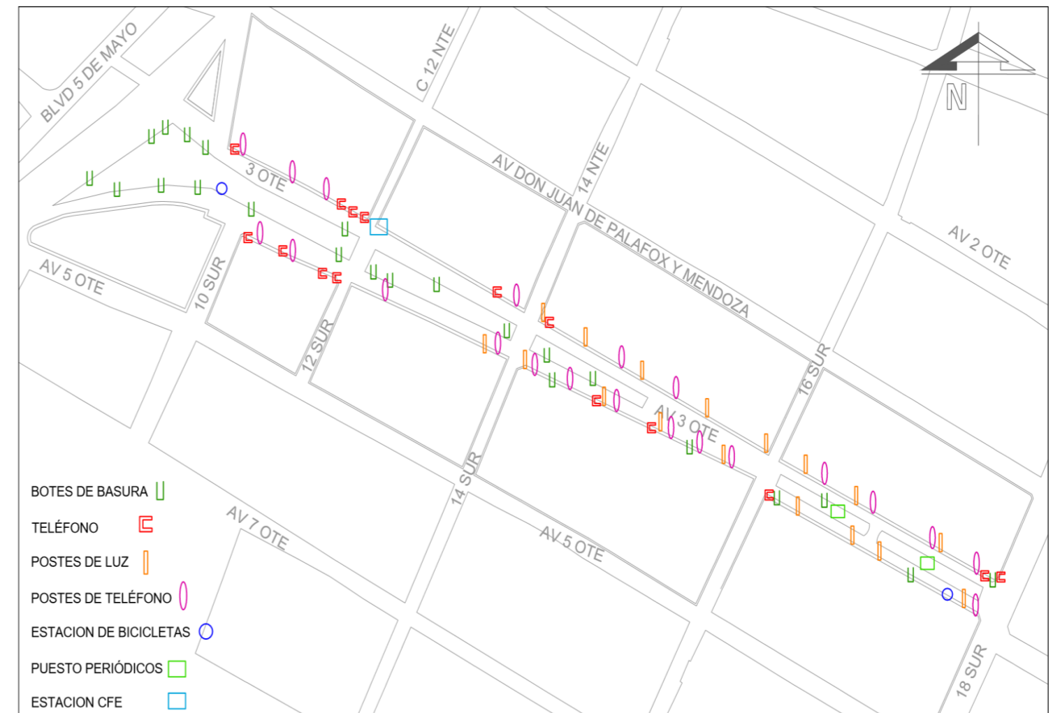
Imagen 2.27 Plano de Mobiliario Urbano Levantamiento
