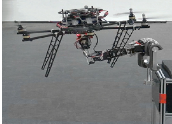
Figura 1.12: Manipulador aéreo construido con un mini helicóptero de cuatro rotores y un brazo robótico.
