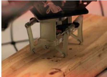
Figura 1.7: Pinza acoplada a un sistema VTOL sujetando una pieza de madera.
