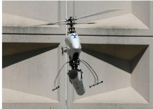
Figura 1.3: Prueba de manipulador aéreo cargando un tubo.
