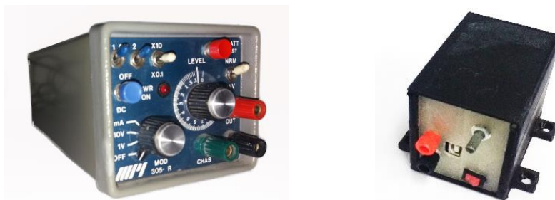
Figura 61. Dispositivos de estimulación eléctrica usados en los experimentos con sujetos voluntarios. En la izquierda: unidad de aislación de corriente (Mod 305R); y en la derecha: dispositivo de estimulación diseñado en este proyecto.
