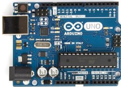
Figura 24. Tarjeta Arduino uno R3. Imagen tomada de (Arduino, 2016). Usa un microcontrolador ATmega328; cuenta con un desempeño idóneo para el dispositivo fabricado en este proyecto de tesis
