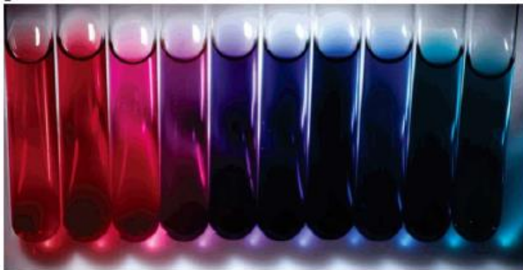
Figura 3: Imagen con el rango de color de soluciones de nanoesferas huecas de oro. El color de la disolución va cambiando al aumentar el diámetro y espesor de la pared [15]
