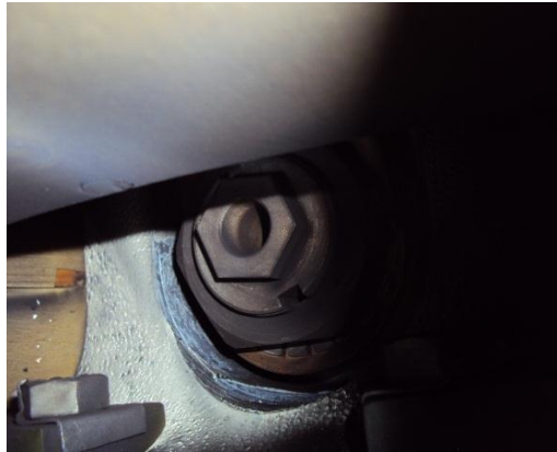
Figura 3.17.- Tornillo de Conexión al interior de la flecha por debajo del cabezal.
