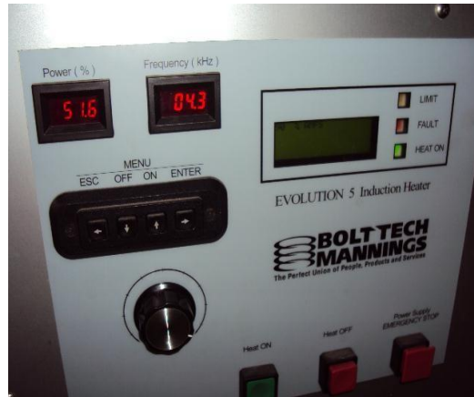
Figura 3.15.- Máquina de Inducción con 51.6 de Potencia a 4.3 Hz. Para calentamiento de los Anillos.
