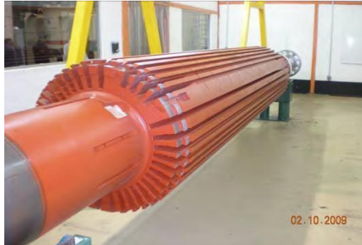
Figura 3.5.- Forja de Rotor de polo liso de 300 MW, sin bobinas y sin anillos de retención.
