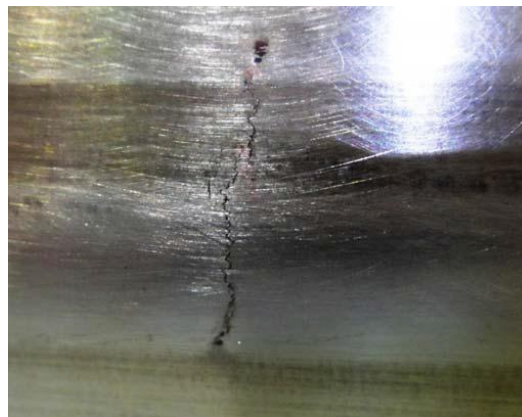
Figura 3.13.- Anillo de Retención 18Mn-18Cr fisurado con 1536 horas de operación. Prueba de análisis metalográfico y Microfotografía.
