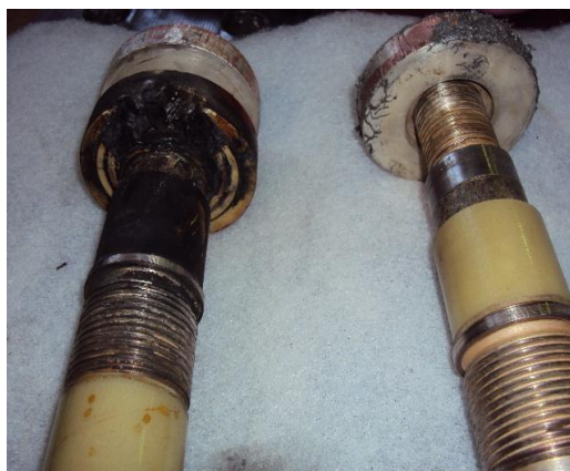
Figura 3.22.- Comparación de Tornillos de conexión, nótese el punto de falla en el tornillo de la izquierda.
