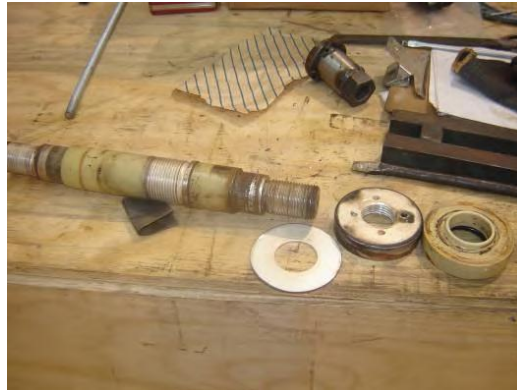
Foto 3. 7- Tornillos de la conexión central al interior de la flecha con el Devanado.
