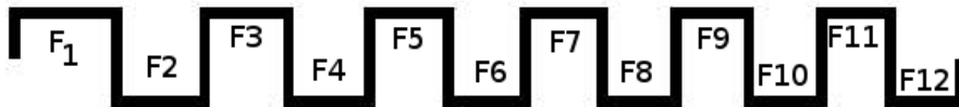
Figura 5.3: Guía de onda doblada la cual representa un oscilador de Dirac. El arreglo es deformado por una ley logarítmica para 11 dímeros y su espectro puede observarse en el panel (b) de la figura 5.2.
