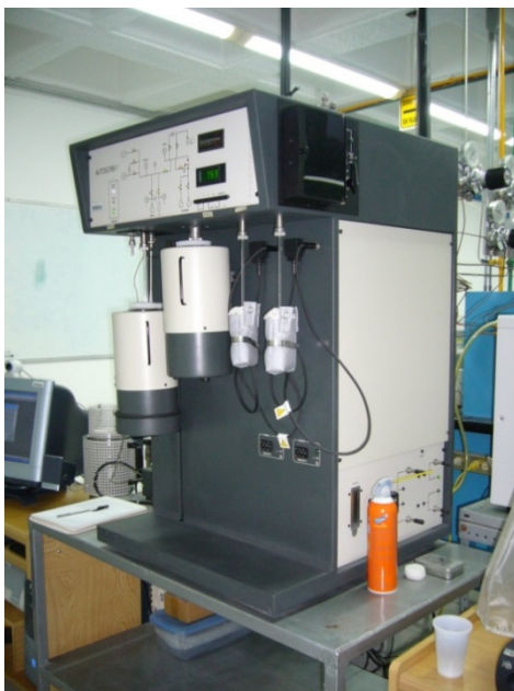
Fig. 17. Equipo de caracterización textural de sólidos en forma de polvos Autosorb-1C-MS de Quantachrome.
