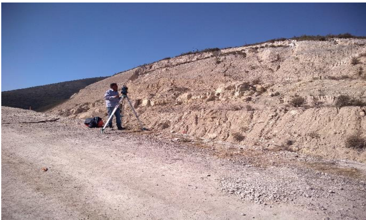
Figura 32.- Levantamiento a detalle de arroyo de vialidad.
