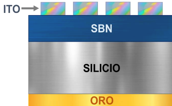
Figura 2.1 Diagrama de las estructuras tipo MOS realizadas
