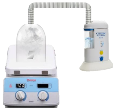
Figura 2.2 Esquema del arreglo utilizado para el depósito de las películas de SBN.
