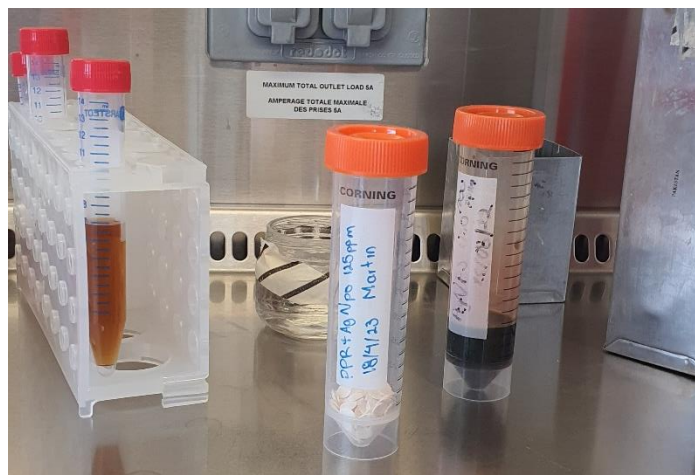
Anexo 3: Soluciones de nanopartículas de plata (AgNPs). El tubo de 15 ml (tapa roja) contiene la solución de AgNPs a 125 ppm, el tubo de 50 ml de enfrente contiene las piezas de PPR que recibirán la solución de AgNPs a 125 ppm. Autoría Propia
