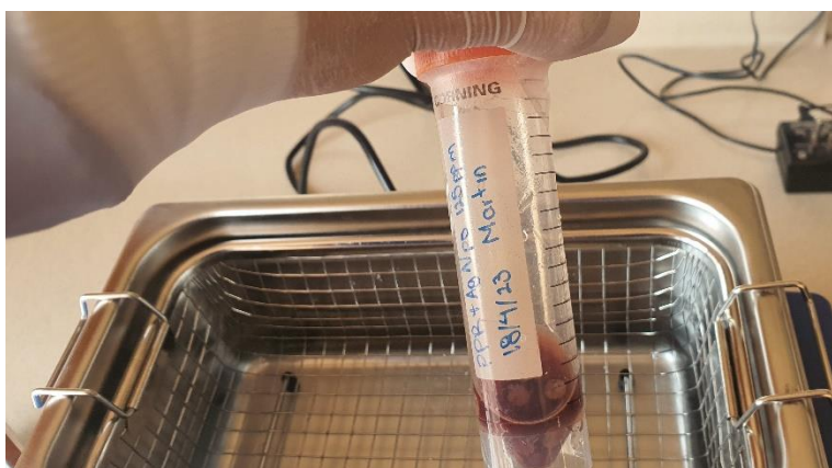
Anexo 4: Sonicación de las piezas de PPR impregnadas con nanopartículas de plata (PPR+AgNPs). Las piezas tras las 24 horas en agitación con la solución se tiñen con las AgNPs. Autoría propia.
