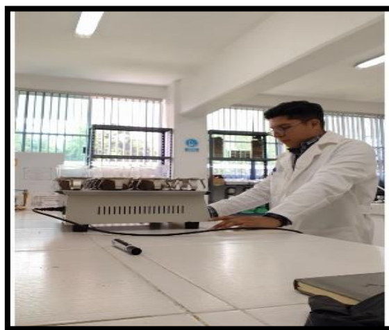
Figura 5. Agitación en el agitador de vaivén a 180 rpm
