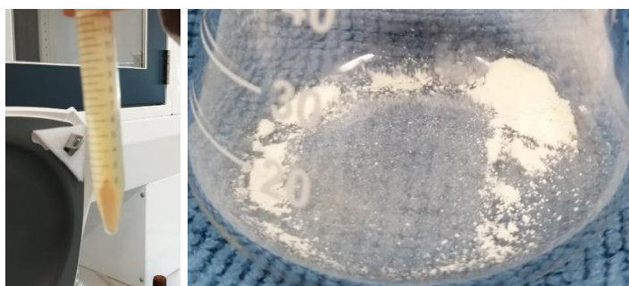
Imagen 2. Muestra de NPs de \text{TiO}_2 . Antes y después del tratamiento térmico
