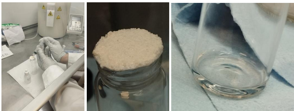
Imagen 6. Fotografías del proceso para realizar la prueba de remoción de arsénico en agua mediante la membrana conseguida
