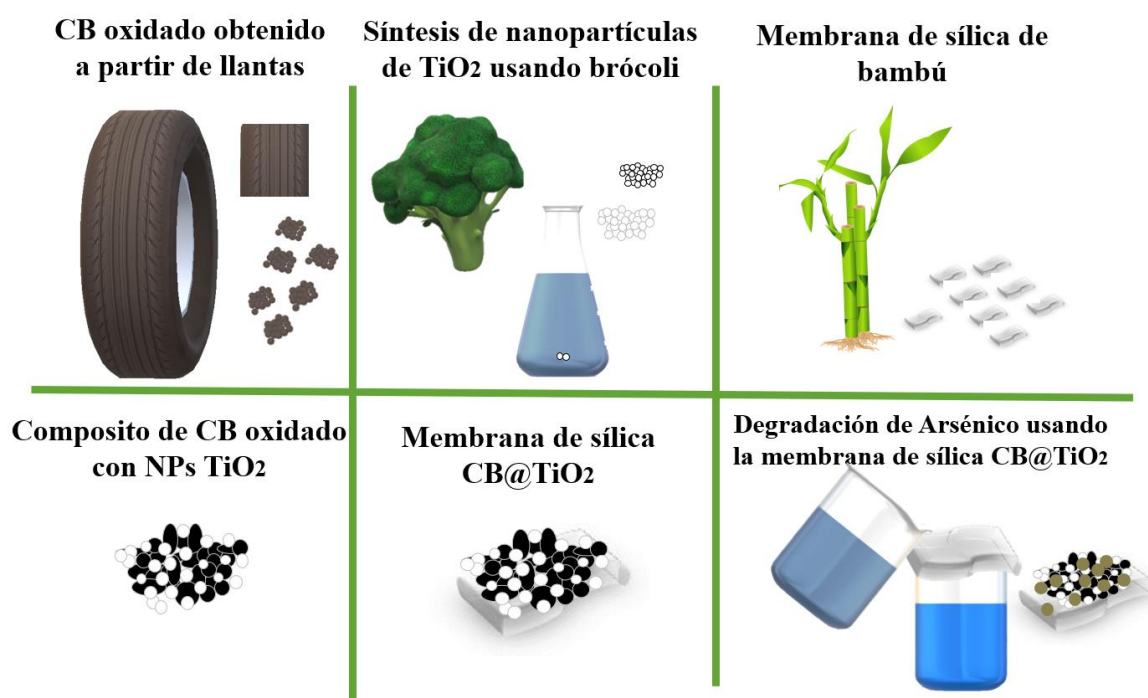
Figura 9. Esquema general del desarrollo experimental para la obtención de una membrana que remueva arsénico en agua
