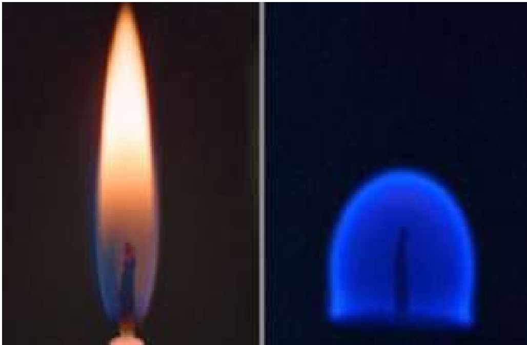
Figura 2. Cambio en la forma de la flama de una vela cuando está en caída libre. (Imagen proporcionada por el profesor Adrián Corona).
