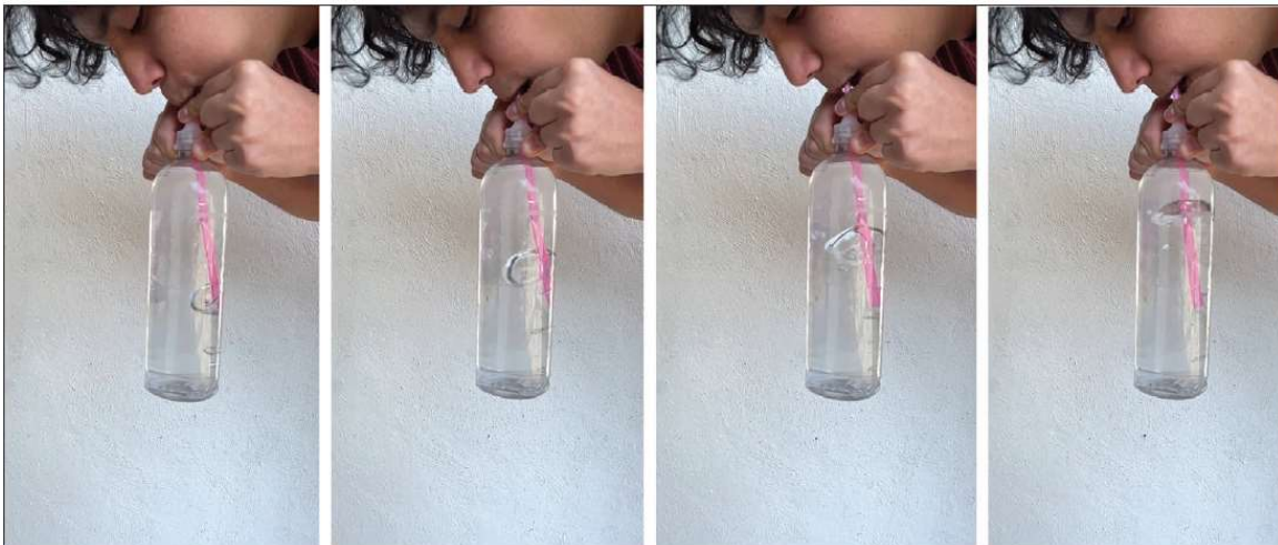
Figura 8. Comportamiento de la burbuja cuando el sistema está en reposo.
