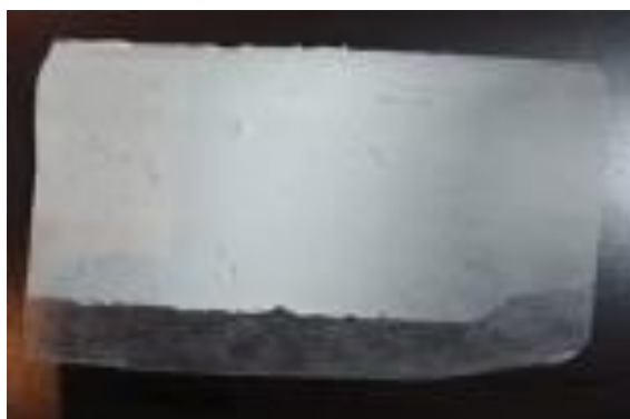
Figura 34. Membrana elaborada de PVA/PLA por método de electrohilado.
