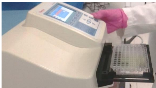
Figura 15. Lectura de absorbancias en fotómetro para microplacas a 760 nm.
