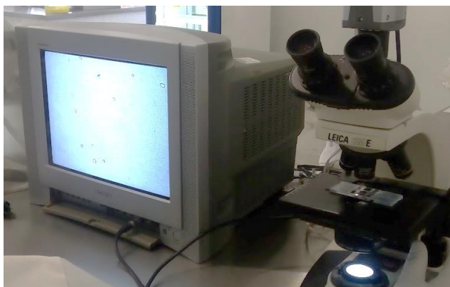
Figura 29. Equipo de conteo de fibroblastos en cámara de Neubauer.
