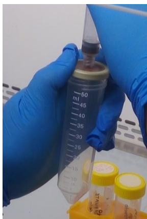
Figura 13. Filtración de extractos.
