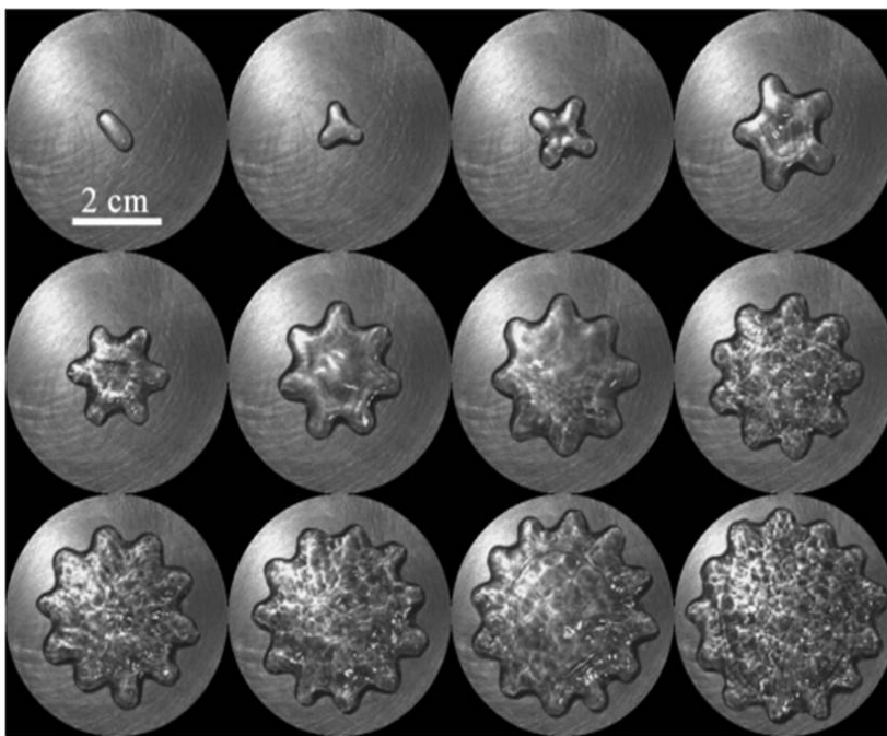
Figura 2.11: Patrones de oscilación observados en gotas en estado leidenfrost [31], sobre un sustrato de aluminio a 350 °C. Los modos observados de n = 2 a n = 13 .
