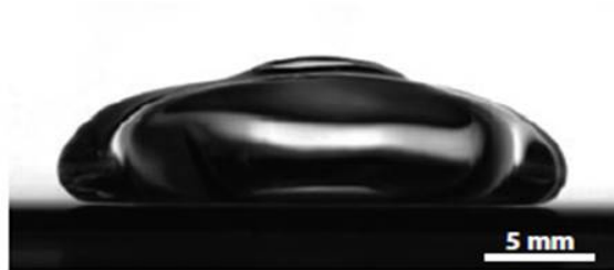
Figura 2.9: Gota en estado leidenfrost “grande”, aplanada por la gravedad, se muestra la formación de una chimenea que genera un domo en la parte superior de la gota, imagen de [4].
