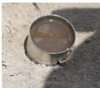
Figura 7. Cilindro con agua para la determinación de la conductividad hidráulica saturada.
