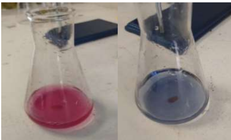
Figura 18. Muestra antes y después de titular para la determinación de magnesio.
