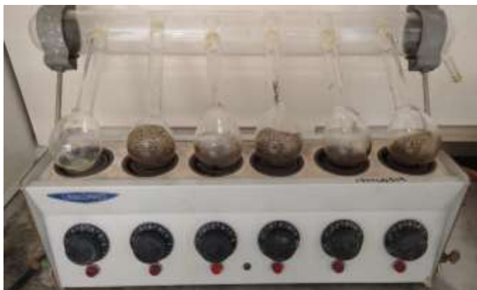
Figura 19. Muestras de suelo en digestor Kjeldahl para la determinación de nitrógeno total.
