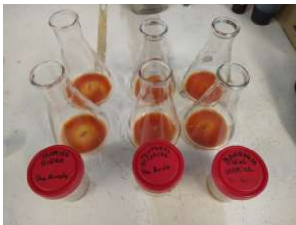
Figura 17. Muestras tituladas para la determinación de cloruros.
