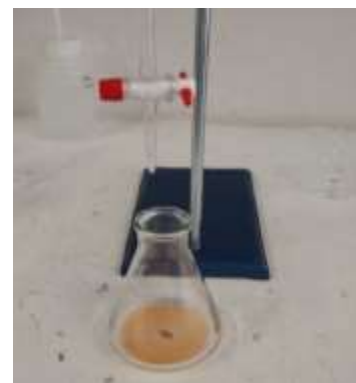
Figura 16. Muestra titulada para la determinación de bicarbonatos.
