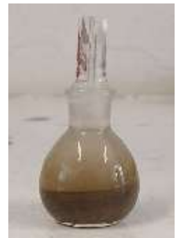
Figura 10. Picnómetro con suelo y agua para determinar densidad real.
