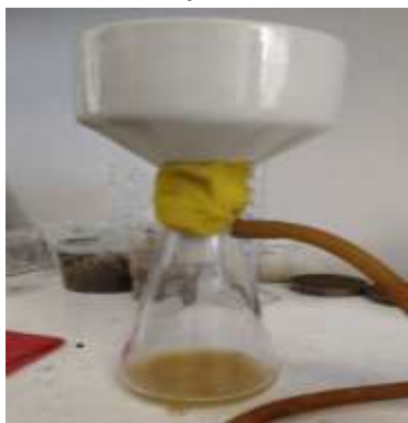
Figura 14. Extracto de saturación filtrado en matraz kitasato a través de embudo Büchner
