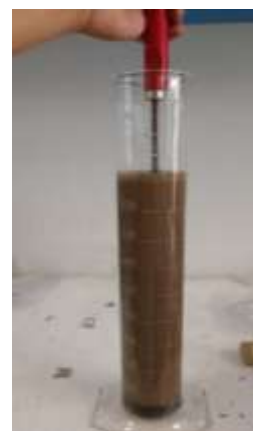
Figura 12. Probeta con muestra en agitación para determinación de textura.
