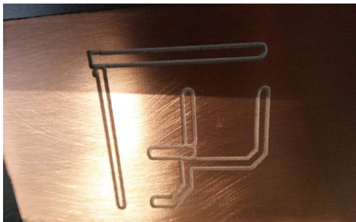
Figura 5.9: Placa de circuito impreso maquinado con el CNC
