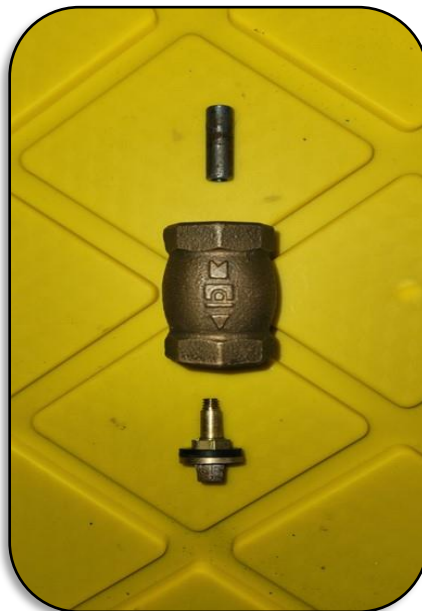
Imagen 3. Configuración de la válvula de impulsión
