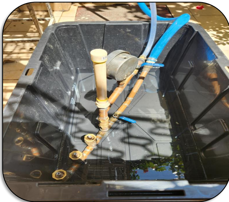
Imagen 13. Bomba de Ariete Hidráulico con tanque de aire de 20 cm (Escenario 3)
