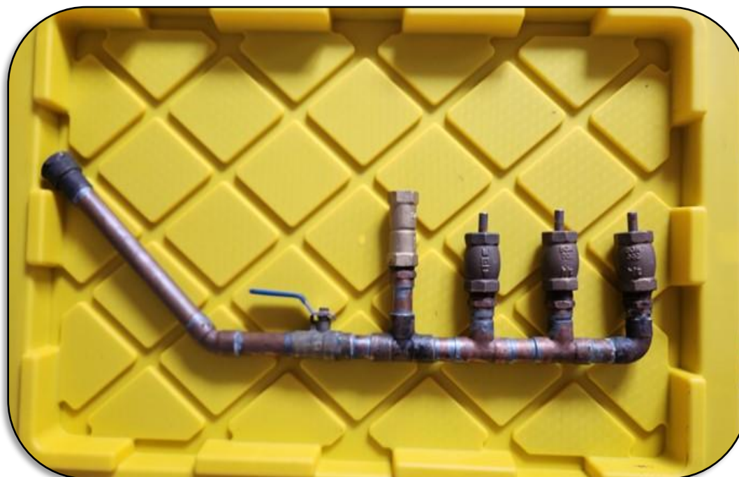
Imagen 4. Conexión de las zonas A, B y C
