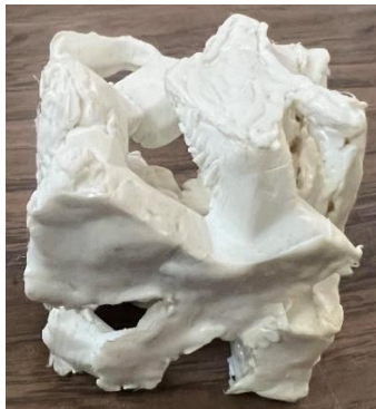
Fig. 31: Andamio de PCL obtenido por impresión 3D inversa
