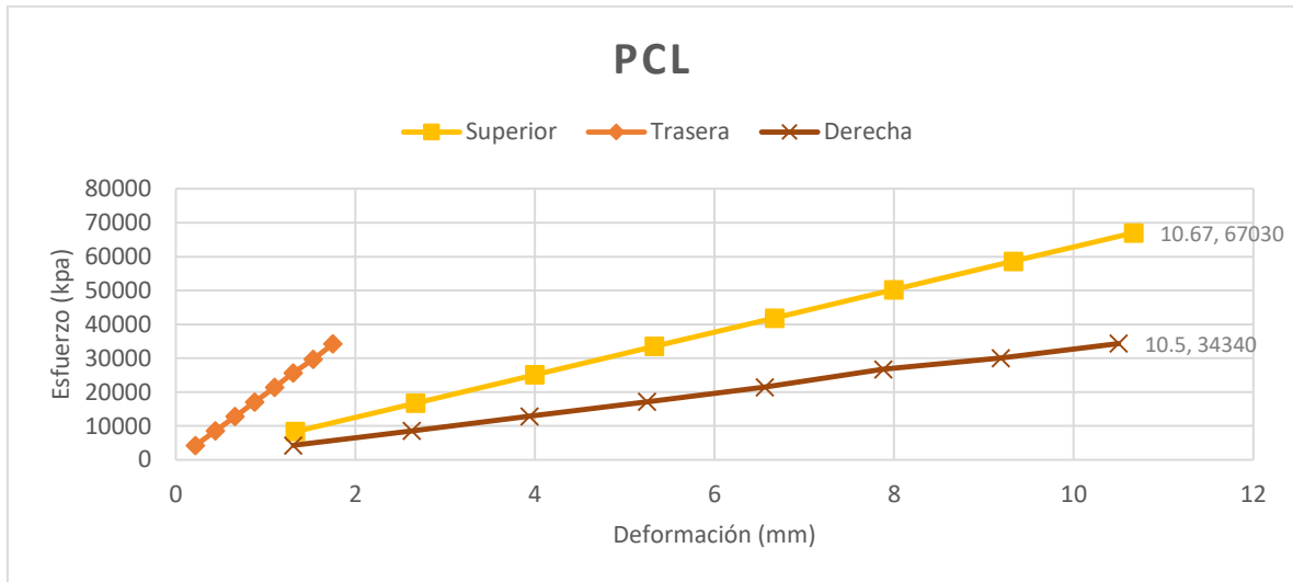
Fig. 37: Comportamiento mecánico que presenta un andamio polimérico compuesto de Policaprolactona en FreeCad, nótese que es muy similar al del hueso esponjoso.
