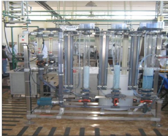
Figura 5. 22 Sistema de fluidización líquido-sólido del L.O.U.
