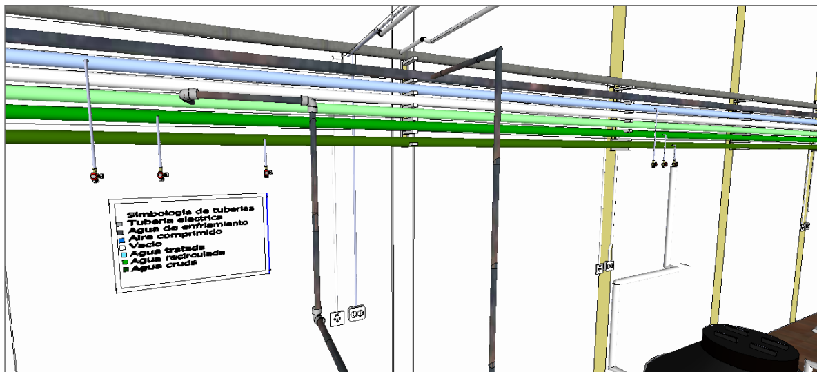
Figura 4.32.- Imagen Virtual del conjunto de tuberías con las que se dan diferentes servicios al lado noroeste L.O.U. incluyendo al equipo de agua de enfriamiento.
