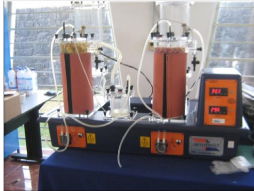
Figura 5. 11 Fotografía de los reactores anaerobios del L.O.U.
