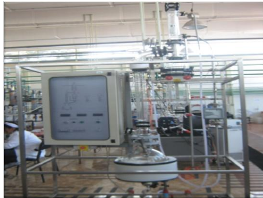
Figura 5. 15 Sistema de extracción solido-liquido del L.O.U.
