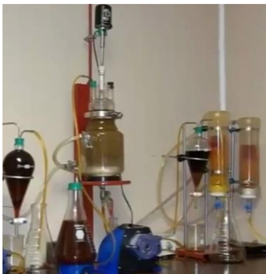
Figura 10. Producción de biodiesel por método enzimático.
