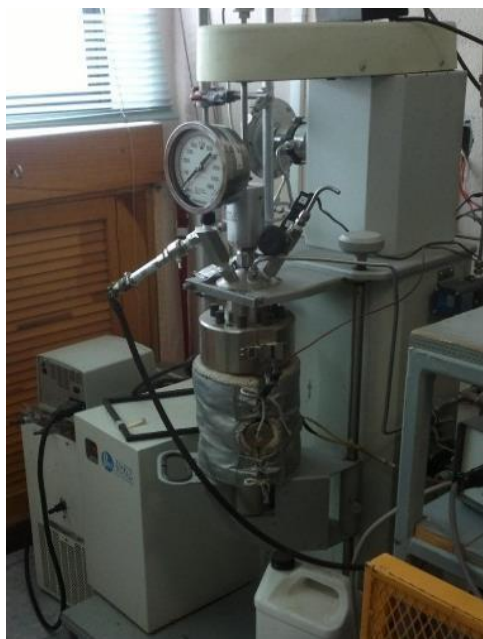
Figura 8. Producción de biodiesel en condiciones supercríticas.
