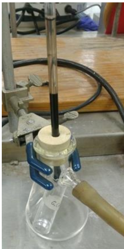
Figura 27. Decoloración de glicerol en sistema de columna a vacío.
