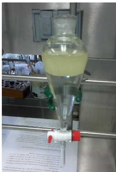
Figura 16. Extracción líquido-líquido para purificación de glicerina cruda.
