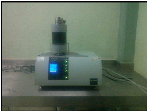
Figura 18. Equipo para análisis termogravimétrico marca NETZCH modelo STA 449F3 JUPITER.
