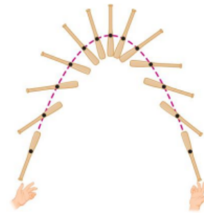
Figura 1.19: El centro de masa (punto negro) de un bate de béisbol lanzado al aire sigue una trayectoria parabólica, pero todos los demás puntos del bate siguen trayectorias curvas más complicadas.[13]
