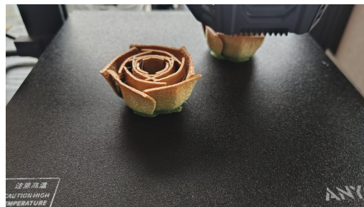
Figura 1.4: Avance en la impresión, nótese el avance por capas.
