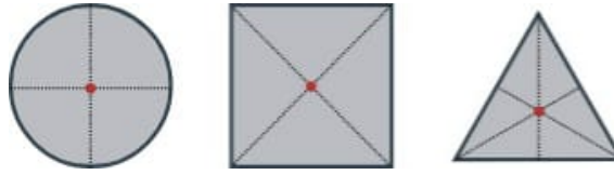
Figura 1.16: Ejemplos de polígonos regulares donde su centro de masa se ubica exactamente en su centro y sobre la superficie del objeto. [23]
