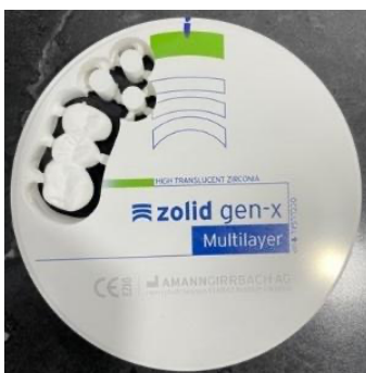
Figura 1. Disco de Zirconia (quinta generación) que se utiliza en laboratorio para la fabricación de estructuras dentales. Fuente propia
