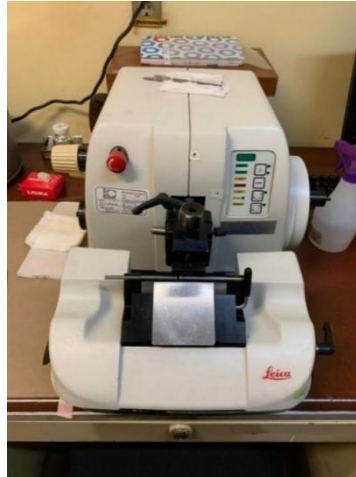
Figura 19 Microtomo utilizado para hacer los cortes a los órganos incluidos en parafina.
