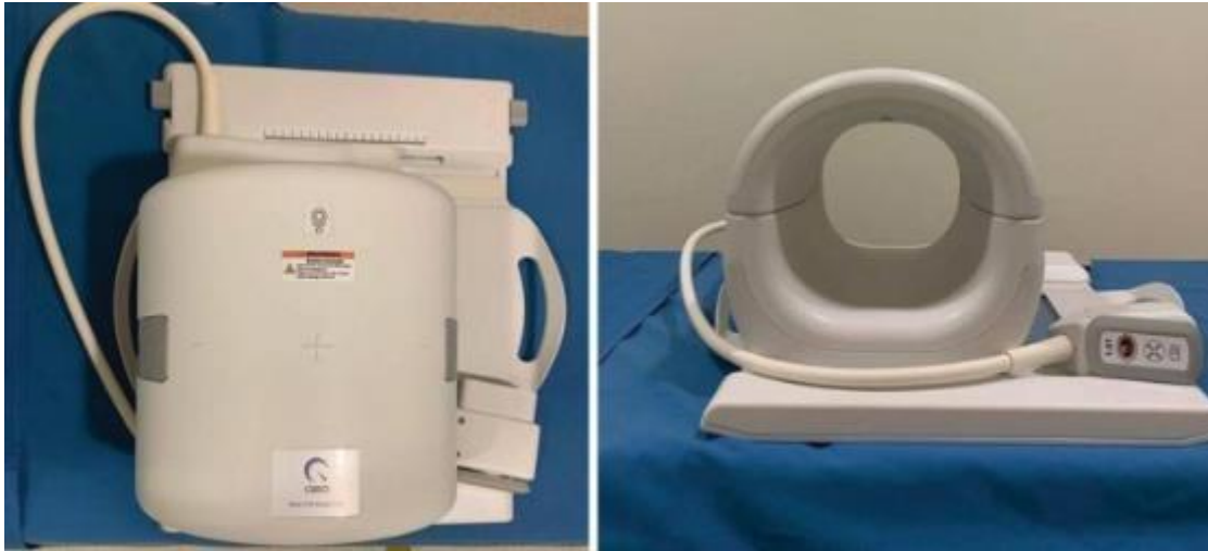
Figura 13. Fotografías de una bobina de rodilla combinada de transmisión/recepción dedicada de 16 canales. Fuente: Subramanian, M., Chin, HSH, Peh, WCG (2023). Imagen de resonancia magnética. En: Davies, M., James, S., Botchu, R. (eds) Imágenes de la rodilla. Radiología Médica(). Springer, Cham (76).
