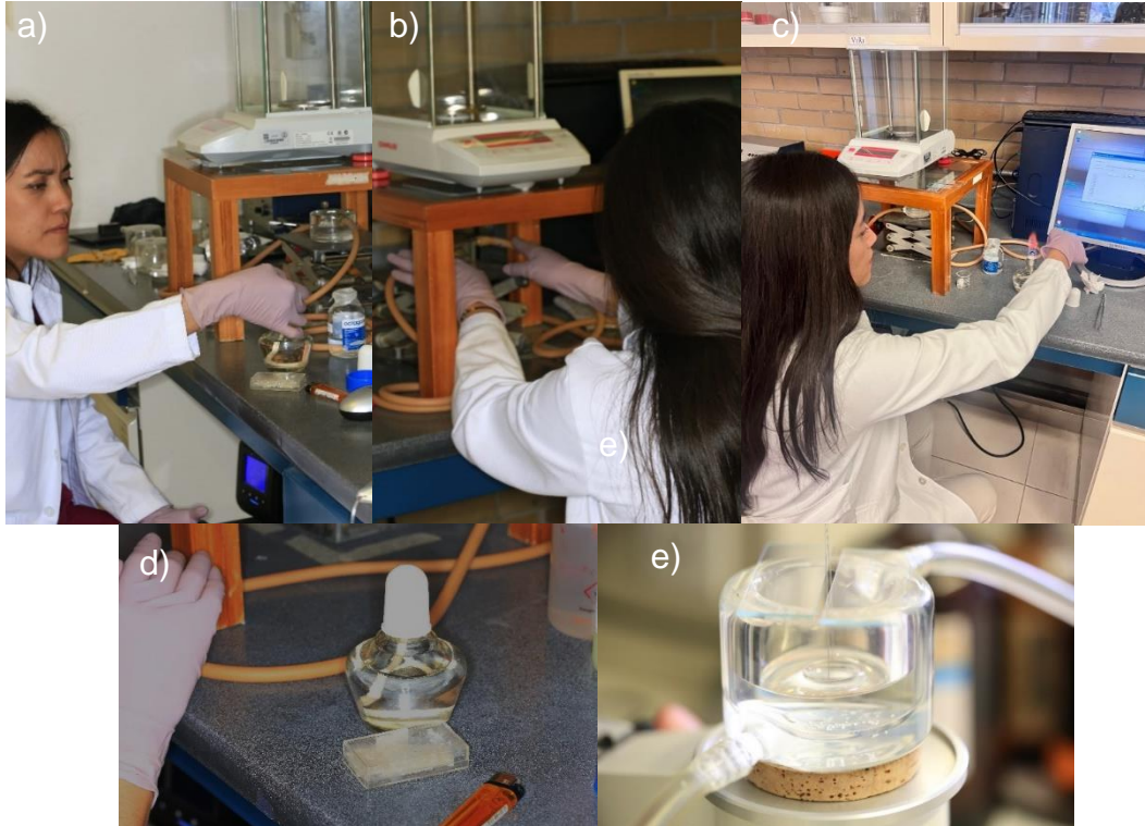
Imágen 8 Flameado de la placa de platino iridio, y lectura del programa SPDC al acercar la celda a la solución.
