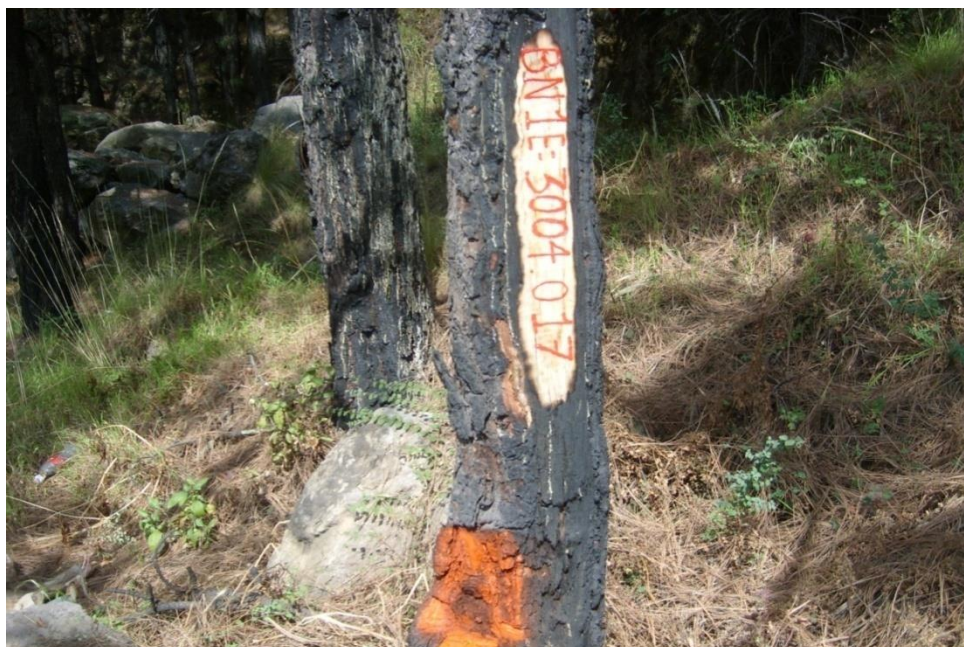
Figura 4.- Detalle del Banco de nivel, Tramo Km. 62+000.
