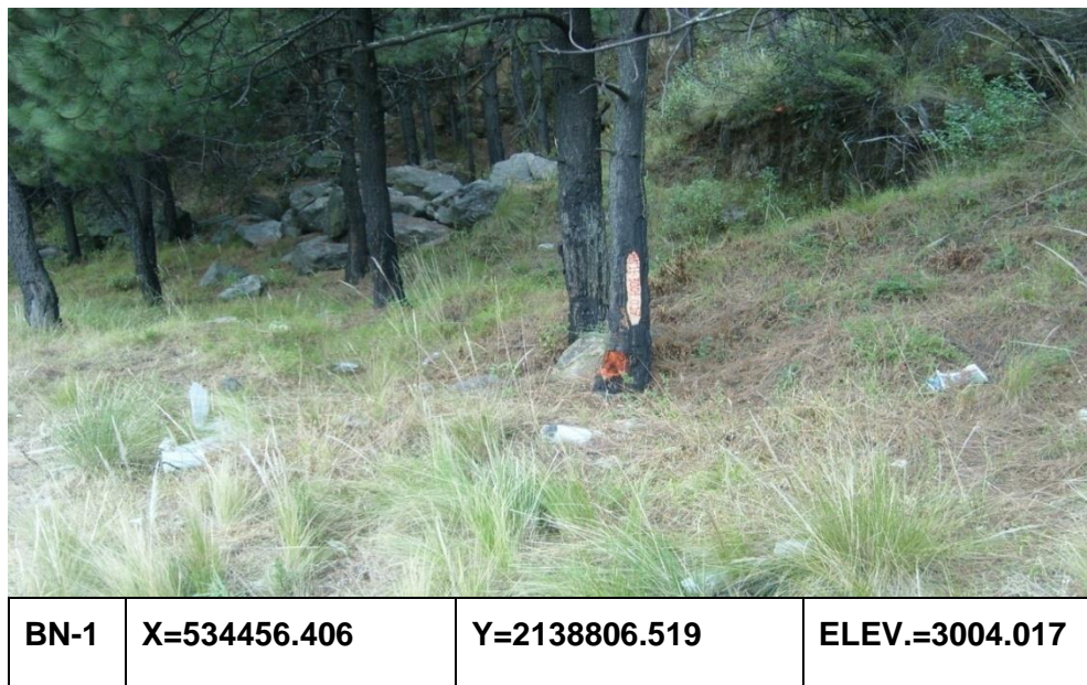
Figura 3.- Banco de nivel para el Tramo Km. 62+000.
