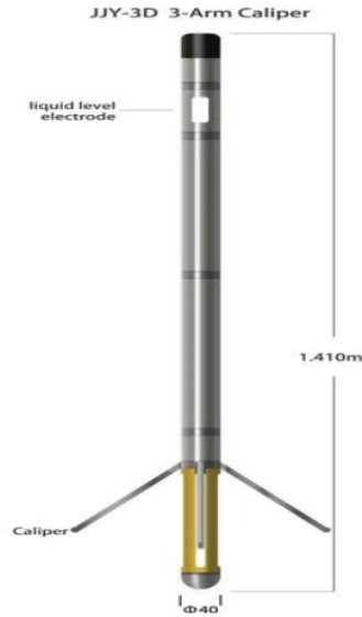
Figura 22. Esquema básico de un Caliper (Co., s.f.)
