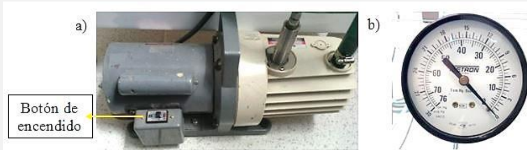
Figura 2.10. a) Bomba de vacío rotatoria Hitachi modelo 160VP y su b) manómetro Metron modelo 63100.
