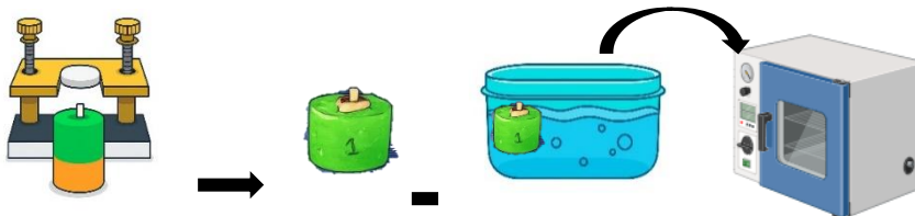
14D. Muestra en resguardo en el horno por 24 horas
