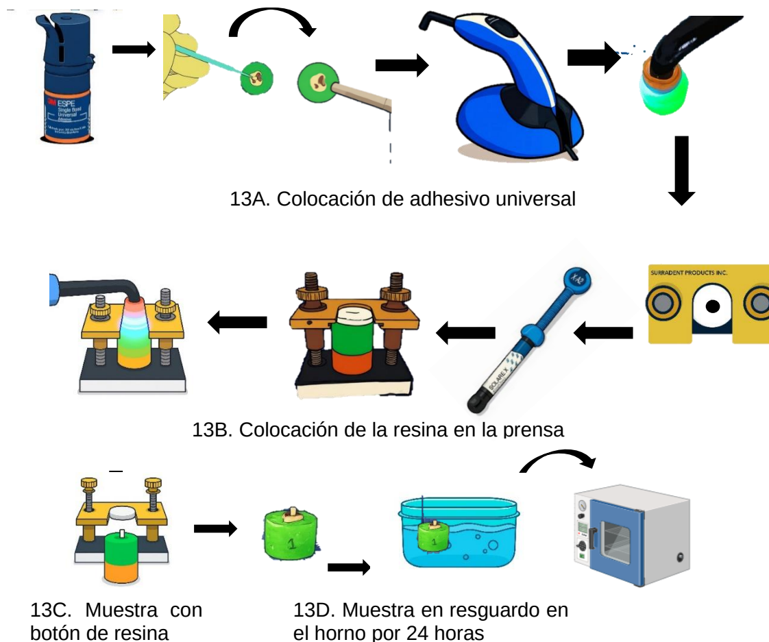
Figura 13. A) Colocación de adhesivo universal; B) Colocación de la resina en la prensa; C) Muestra con botón de resina; D) Muestra en resguardo en el horno por 24 horas.
