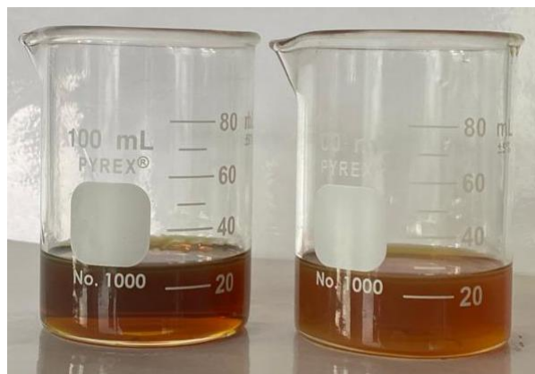
Figura 3.15 Clarificación de diésel crudo con arcilla tratada con 2-propanol
