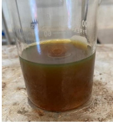
Fig 2.1 Agitación de diésel con arcilla clarificante
