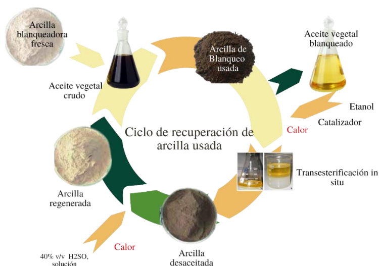
Figura 1.3 Ciclo de recuperación de arcilla usada (Adaptación de Sedghamiz et al., 2019)
