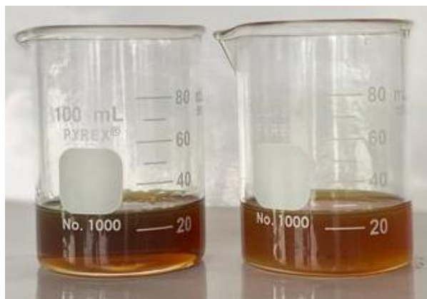
Figura 3.14 Clarificación de diésel crudo con arcilla tratada con hexano
