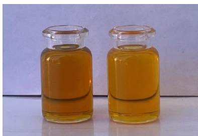
Figura 3.4 Comparación de la coloración del diésel antes y después de clarificación con 1% de arcilla bentonita.
