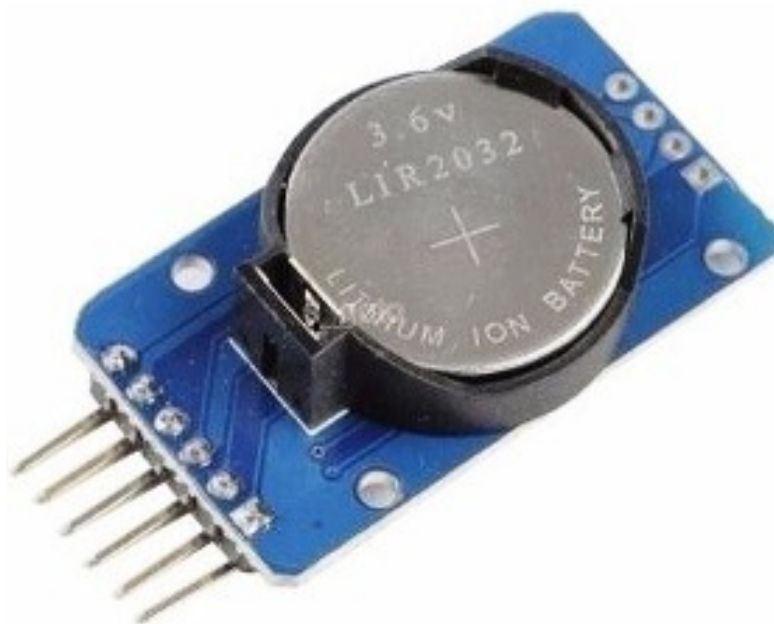
Figura 4.13: Reloj en tiempo real DS3231 usado en el sistema de iluminación.
