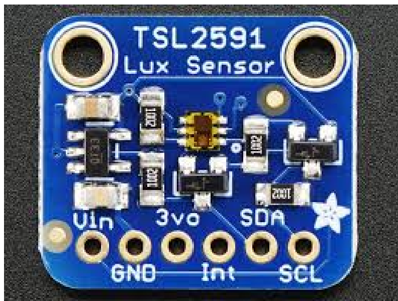
Figura 4.14: Sensor de intensidad lumínica TSL2591 usado en el sistema de control de iluminación.
