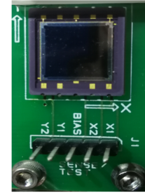
Figura 2.10: Vista frontal del PSD de la plataforma QUANSER™ [62].
