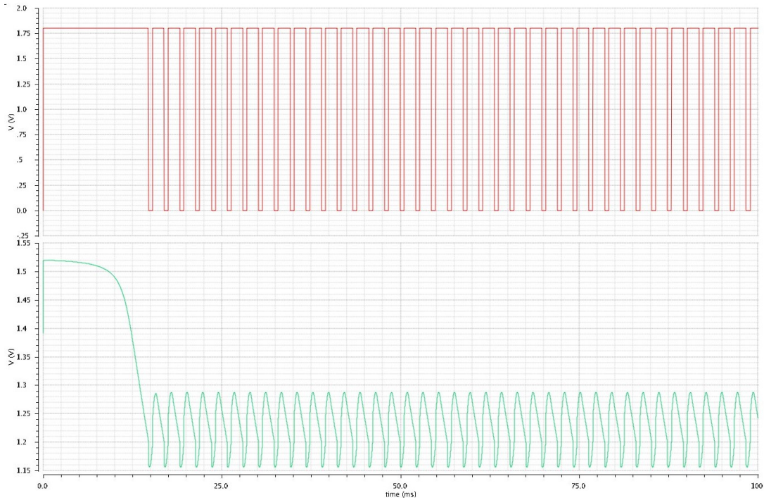
Figura 5.12: Respuesta para V_d = 1.2 V con E = 5 V.
