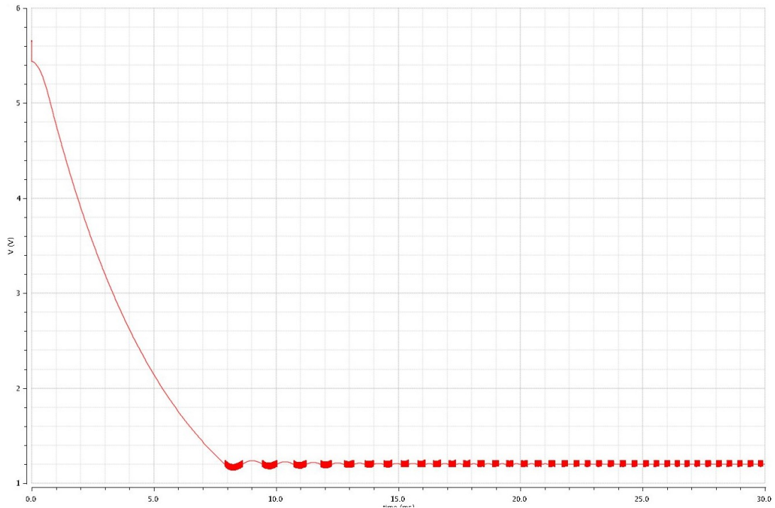
Figura 5.7: Respuesta del control para V_d = 1.2 V.
