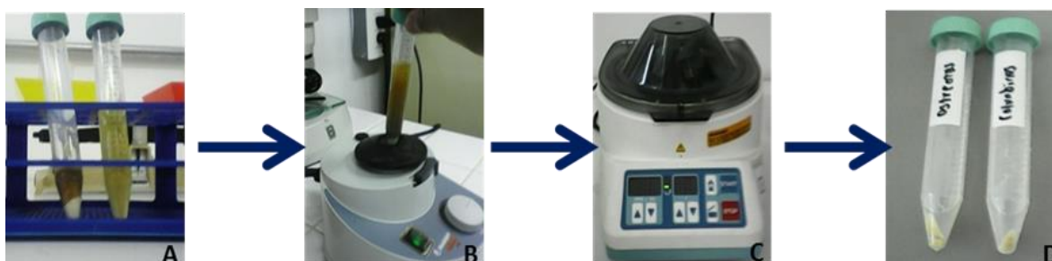
Figura 8. Proceso de obtención del extracto. A) Muestra con arena de mar y solución salina, B) Agitación durante 5 min, C) Centrifugación a 8000 rpm, D) Recuperación del precipitado.
