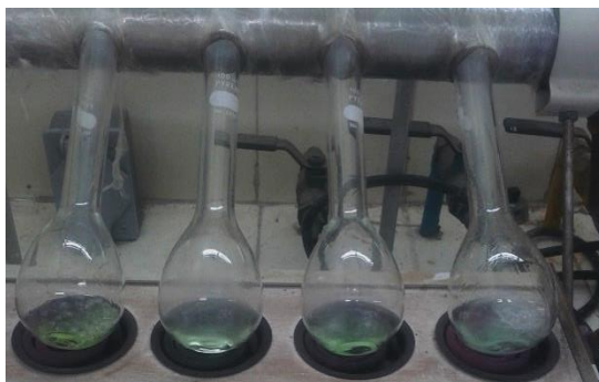
Figura 13. Oxidación de la materia orgánica y conversión del nitrógeno (proveniente de proteínas) en ion amonio mediante el calentamiento del ácido sulfúrico y catalizadores.
