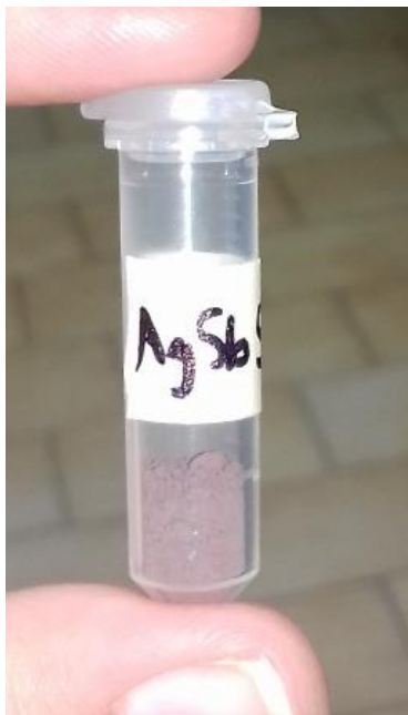
Figura 3. 8. Material Ag_3SbS_3 listo para ser caracterizado.
