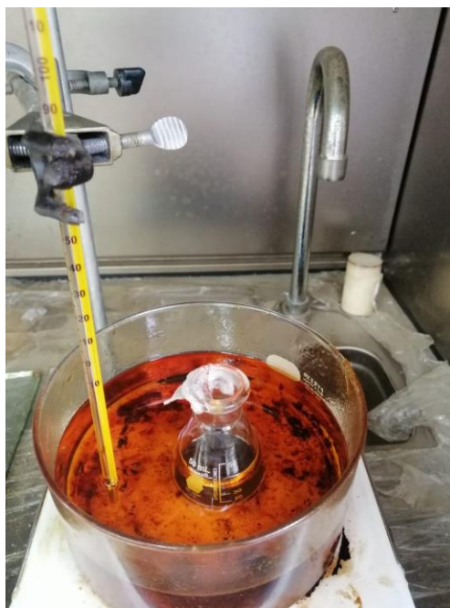
Figura 3. 10. Solución precursora sometida a baño térmico por 60 minutos.
