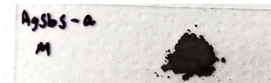
Figura 4. 4. Muestra AgSbS-a sintetizada por el método combinatorio de precipitación química con SbCl_3 a 160^\circ C por 1 h y post-solvotermal a 180^\circ C por 6 h, utilizando EG como solvente, depositada en un sustrato de vidrio, para realizar caracterización Raman.
