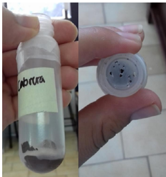
Figura 3. 4. Partículas de Ag_3SbS_3 obtenidas después de ser lavadas tres veces con etanol.
