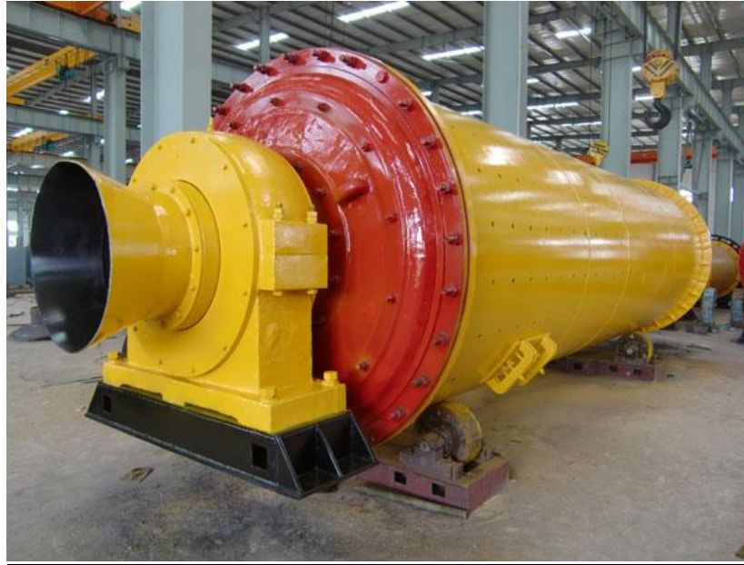
Figura 2.10.2 Molino tipo bolas
