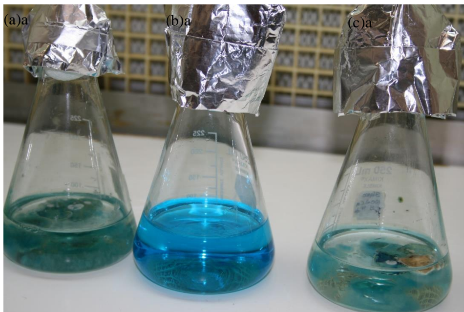
Figura 25. Aspecto del agua contaminada con azul 86 a 30 ppm con G.ganoderma (a) R1 después de la biodegradación (b) Antes de la biodegradación (c) R2 después de la biodegradación.
