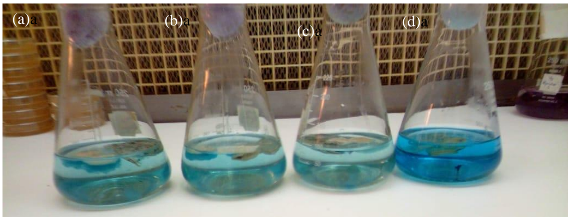
Figura 23. Aspecto del agua contaminada con azul 86 a 30 ppm con P. zapotecorum (a) R3 después de la biodegradación (b) R1 después de la biodegradación (c) R2 después de la biodegradación (d) Antes de la biodegradación.
